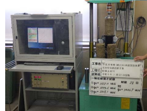
一軸圧縮強度試験
